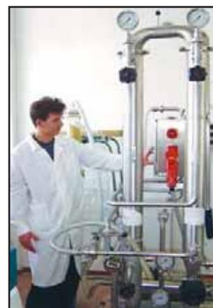
Оборудование, используемое для микро-фльтрации
